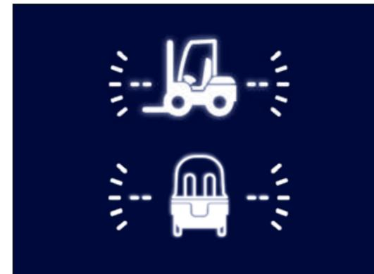
Mientras conduce, la unidad de mando de la máquina (MCU) detecta el movimiento longitudinal y lateral y **alerta al conductor si se superan los valores de estabilidad preestablecidos**.
