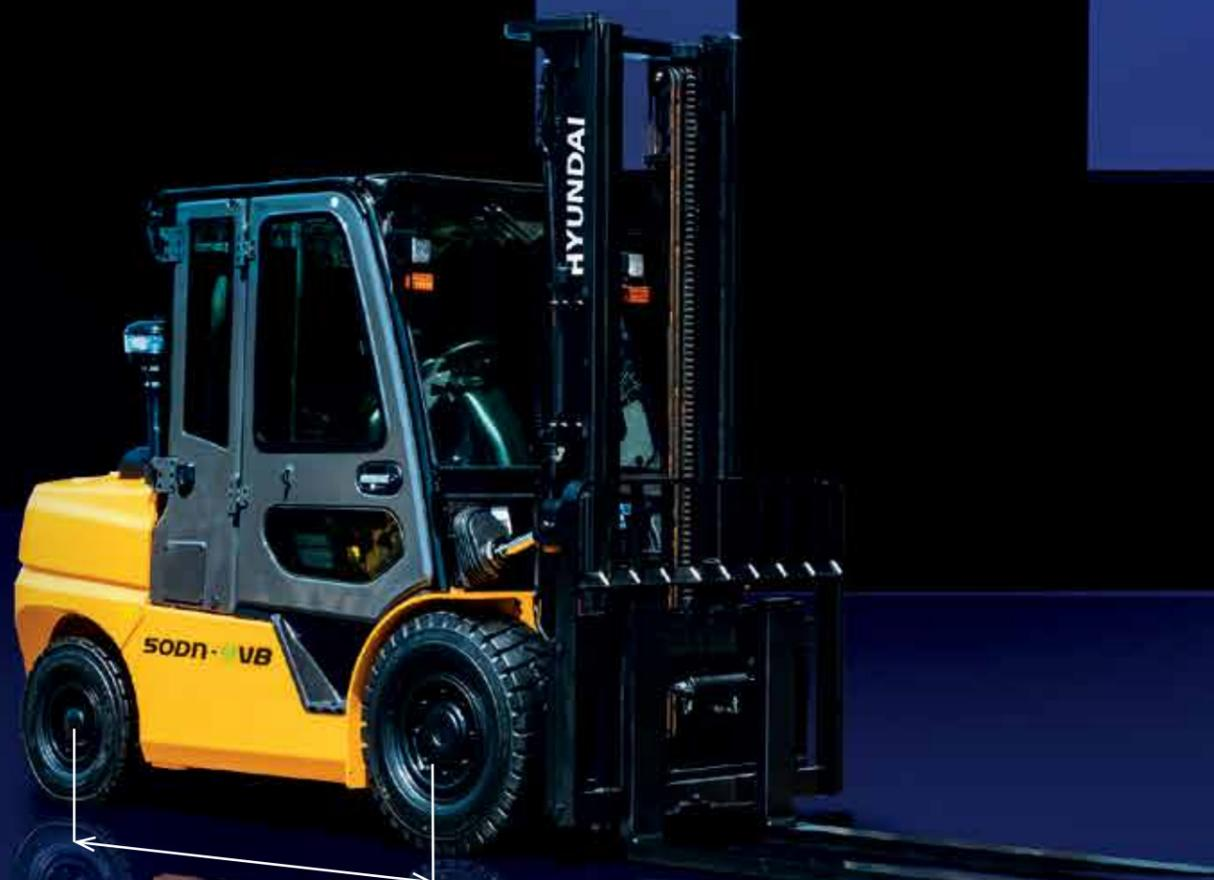
**NUEVO** La distancia entre ejes se ha incrementado para mayor estabilidad y seguridad en 30 mm para las 35D-9VB-40DN-9VB/VC y en 100 mm para las 45-50DN-9VB/VC.
