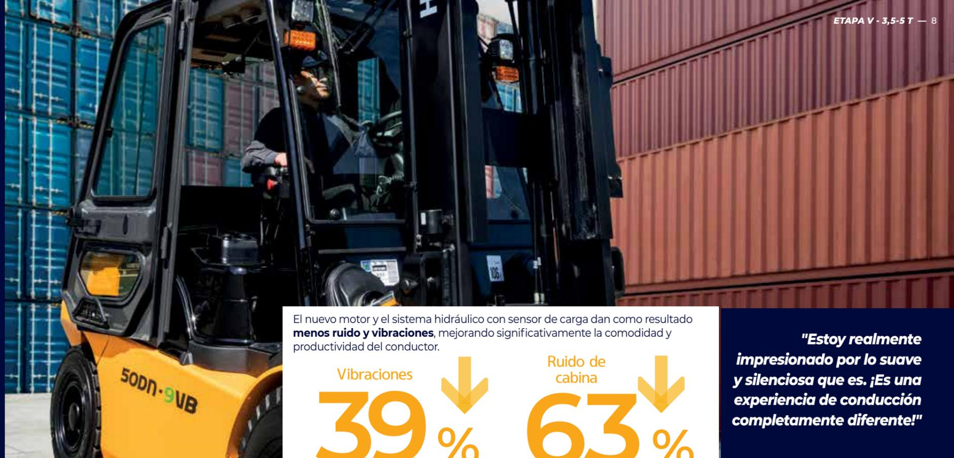
El nuevo motor y el sistema hidráulico con sensor de carga dan como resultado **menos ruido y vibraciones**, mejorando significativamente la comodidad y productividad del conductor.
