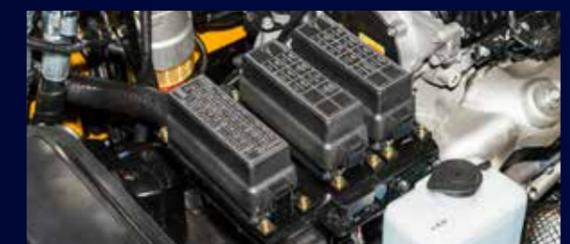
Todos los fusibles y relés están centralizados en tres cajas con **una protección mejorada a prueba de agua y polvo IP65**. Las cajas en sí se encuentran bajo el capó del motor para **acceso rápido**.
