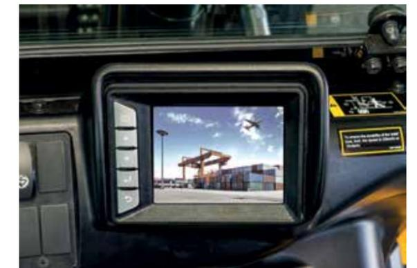
La cámara de visión trasera está integrada en el cuadro y se puede **activar con un botón o automáticamente mientras se conduce hacia atrás**.
