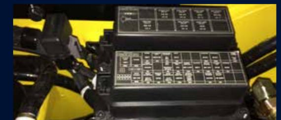
Todos los fusibles y relés están centralizados en tres cajas con **una protección mejorada a prueba de agua y polvo IP65**. Las cajas en sí se encuentran bajo el reposapiés para un **acceso rápido**.
