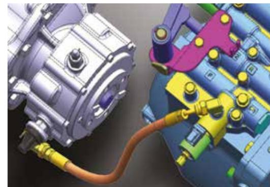
El freno de estacionamiento funciona automáticamente cuando se desconecta la energía para evitar accidentes causados por errores humanos. **El control de asistencia de arranque en pendientes (HAC) previene el retroceso al volver a arrancar en una pendiente.**
