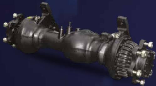
El eje motriz cuenta con un reductor planetario que ofrece resistencia a los cambios de par. El sistema de frenos de disco húmedo garantiza una frenada óptima en cualquier aplicación, y gracias a su alta durabilidad, también contribuye a reducir los costes de mantenimiento y los tiempos de inactividad.
