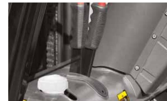
La palanca de trinquete permite frenar con el mínimo esfuerzo y bloquear la posición de la máquina en cualquier circunstancia.
