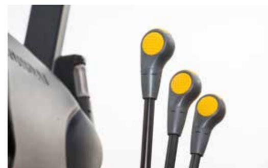
Las palancas hidráulicas de control están dispuestas de forma ergonómica para garantizar un control óptimo.
