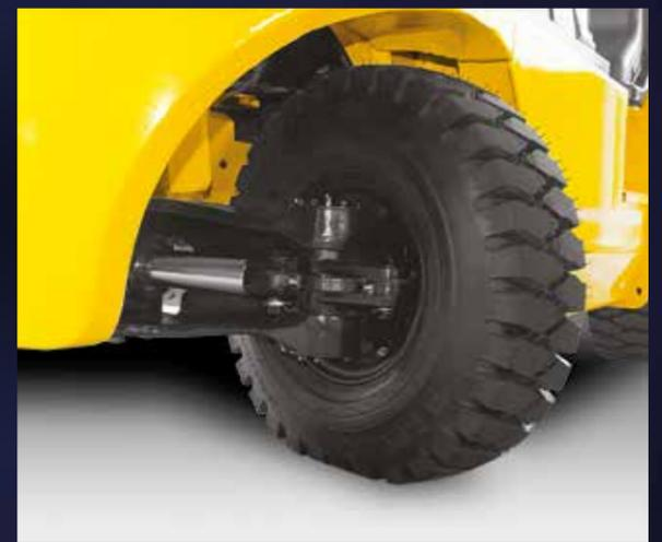
El eje trasero presenta un diseño de alta resistencia con rodillos cónicos para aumentar la durabilidad.
