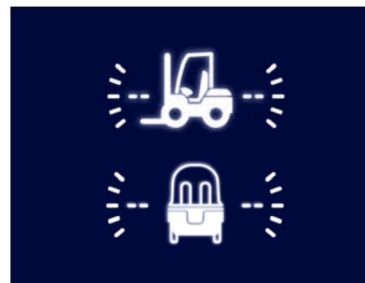
Mientras conduce, la unidad de mando de la máquina (MCU) detecta el movimiento longitudinal y lateral y alerta al operador si se superan los valores de estabilidad preestablecidos.
