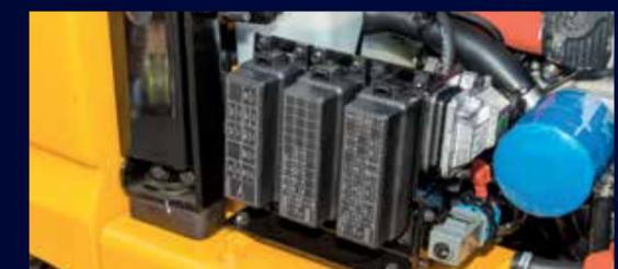
Todos los fusibles y relés están centralizados en tres cajas con una protección mejorada a prueba de agua y polvo IP65. Las cajas en sí están ubicadas detrás del panel de la cubierta lateral para un acceso rápido.
