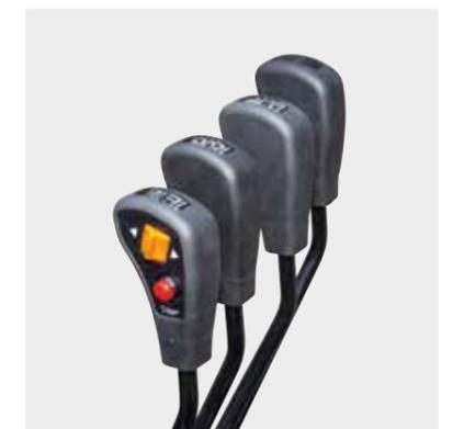
**Interruptor direccional y claxon en la palanca**
